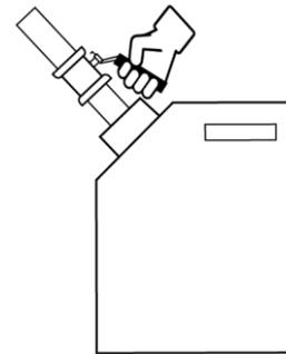
※ 給油缶は、90° 開閉式のバルブをホース途中に設け燃料漏出時に即時対応出来るよう対策することを推奨します。
